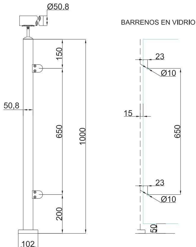
Poste diseñado para barandales modernos, altura de un metro con dos conectores, para tubo de 2", ideal para tramos lineales o curvos de vidrio. Proporciona soporte firme y estético, manteniendo la seguridad y resistencia al desgaste.
